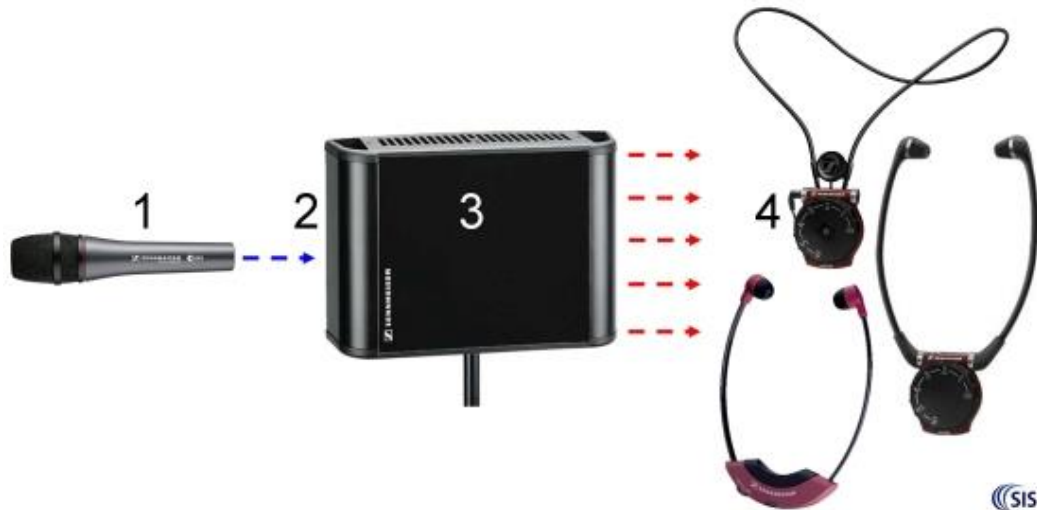
Kuva 2 Infrapunajärjestelmä (Lähde: Sennheiser)
