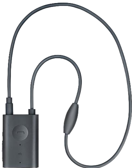
Kuva 30 Puhelimen hands-free käyttöön suunniteltu kaulasilmukka (Lähde: Jentafon Oy)
