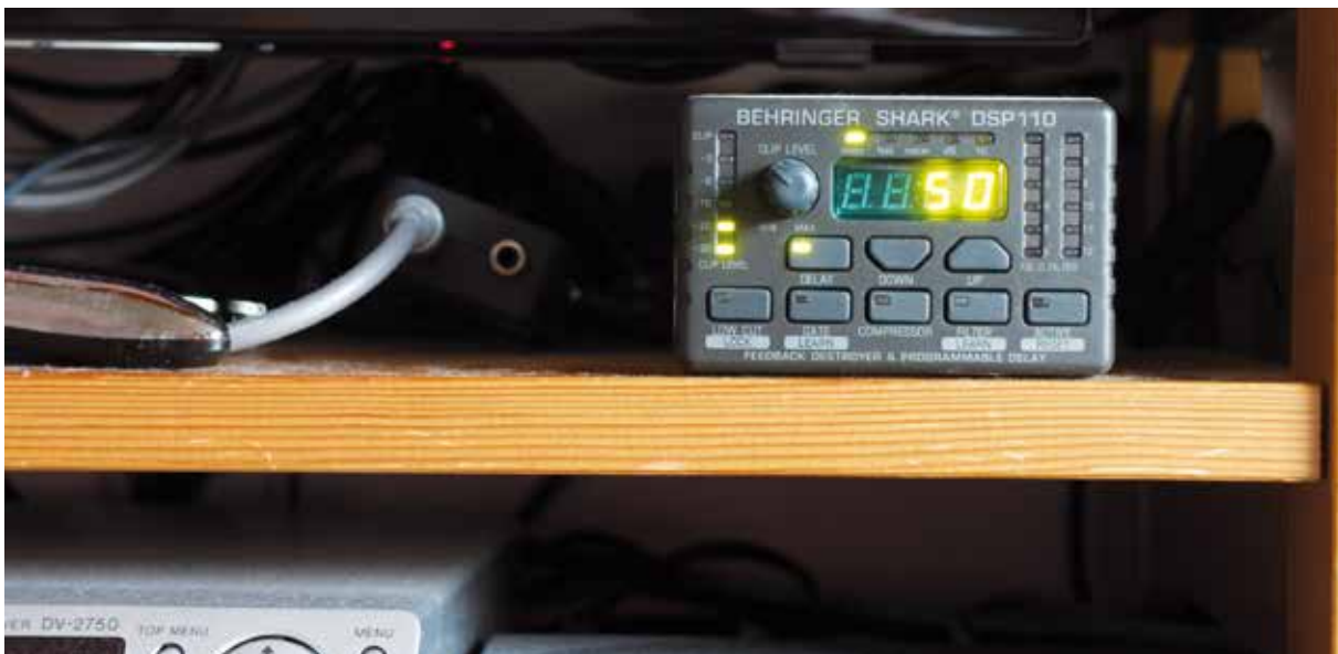
Kuvassa viivelaite, joka on säädetty 50 ms viiveelle. Äänen viiveen säätämisen lisäksi tätä laitetta voi käyttää mm. mikrofoniin esivahvistimena, sillä voi leikata matalia taajuuksia sekä kompressoida äänisignaalia.
