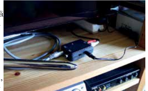
Digitaalisen signaalin analogiseksi muuntava DA-muunnin television alla.
